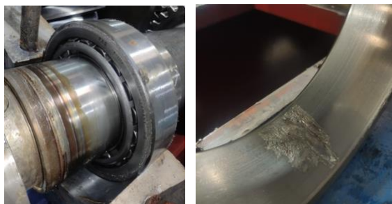
Fig. 7. Daño encontrado en rodamiento eje entrada reductor NGC.
