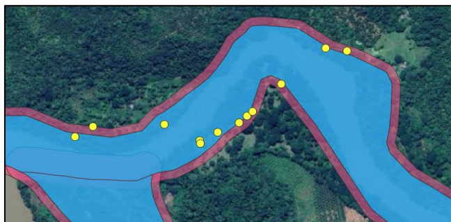
Fig 1. Identificación de apoyos ubicados en ronda hídrica mediante buffer de 30 m e intersección espacial en QGIS
