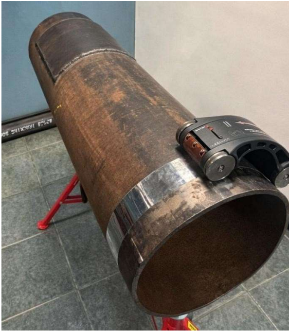
Fig. 4 Posición de la cinta magnetostrictiva y escaner con bobina para inspeccionar debajo del soporte totalmente soldado
