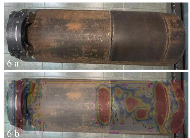
Fig. 6a Vista superior de pieza inspeccionada, 6b Vista superior de pieza inspeccionada con superposición de barrido B-Scan de ondas guiadas de mediano alcance MRUT.
