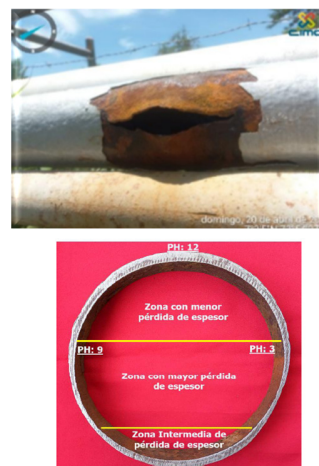
Fig. 6. Análisis de falla en línea de inyección
