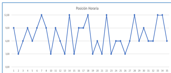
Fig. 4. Posición horaria de bajos espesor en línea de inyección de agua.
