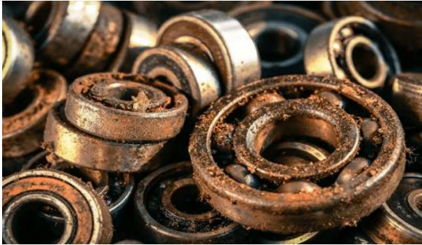
Fig. 1. Corrosión en rodamientos fuente: Interlub (2023). ¿Qué es la corrosión en los rodamientos y cómo la evitamos?
