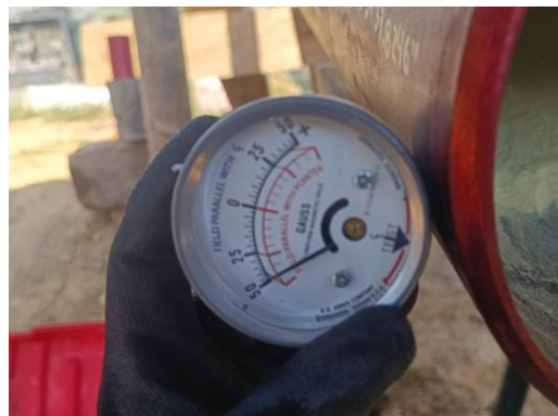
Imagen 4. Medición Inicial del Campo Magnético en la tubería
