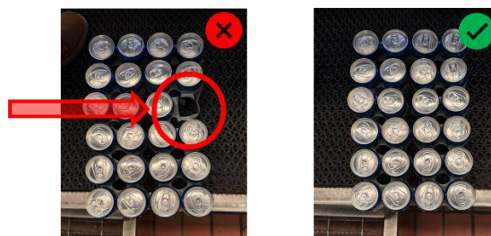
Fig. 1. Identificación de defectos: productos faltantes.
