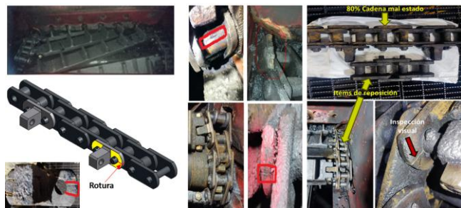
Fig 5, Mecanismos de falla en cadena
