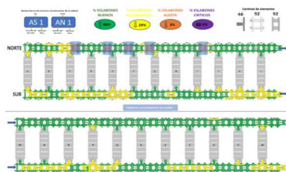
Fig 12, Condición final en eslabones de cadena
