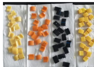
Figura 2. Muestras de tuberías poliméricas nuevas
