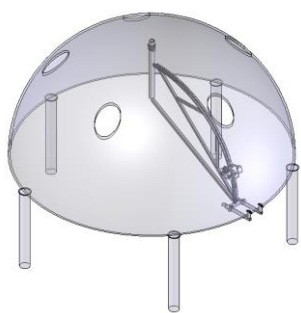
Ilustración 21 Ingeniería hidro demolición de coque y refractario cap Reactor R4201.
