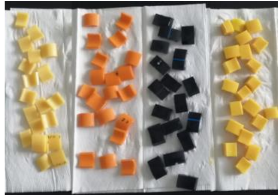
Tubería nueva PEMD (amarilla) – PEAD (naranja) – PEAD (negra) – PA12 (amarilla)
