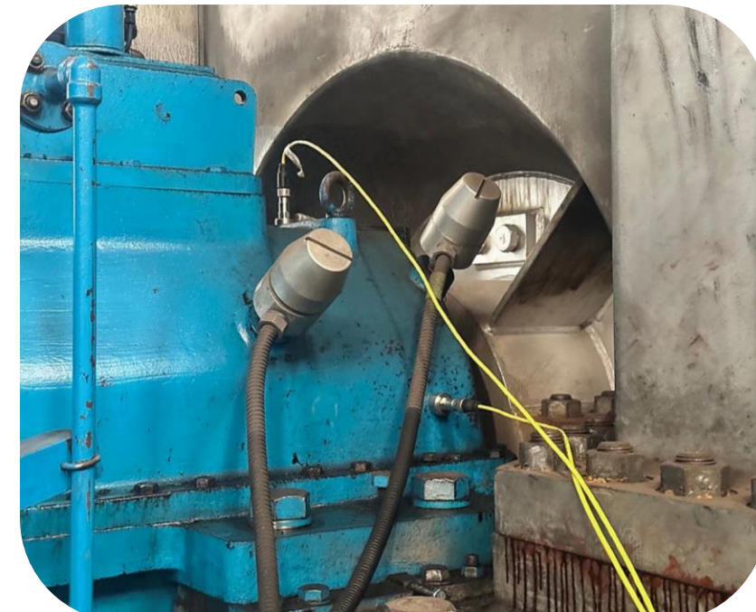
Registro de vibraciones absolutas con acelerómetros sobre carcasa
