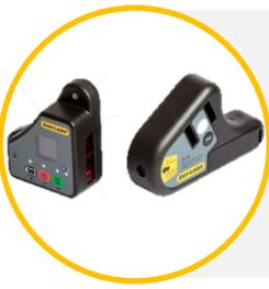
Easy-Laser® BTA se monta magnéticamente en unos segundos, con el transmisor láser en una de las poleas y el detector en la otra. El programa guía al usuario durante el montaje de las unidades. El transmisor genera un plano láser paralelo a la polea de referencia. El detector lee la posición respecto al plano láser y muestra en pantalla, en tiempo real, la desviación y los dos valores angulares. De este modo, la alineación de las máquinas ajustables resulta muy sencilla.
