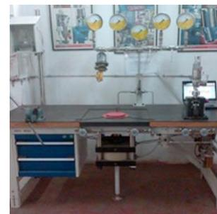
Banco ergonómico de calibración de válvulas de seguridad
